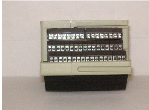
Bild: Klemmleisten für Fühler und LED's (mit Multifunktionskarte)
